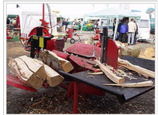
Holzspalter zum maschinellen Zerkleinern von Brennholz
